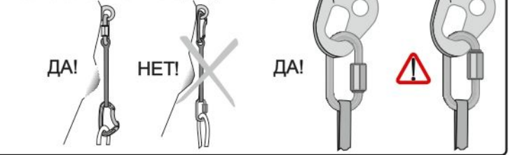
Рис. 6. Использование оттяжек с рапидами «Link 8»
