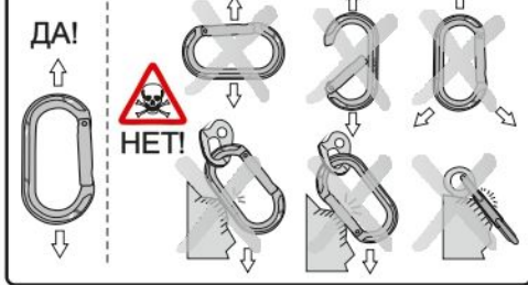
Рис. 2. Приложение нагрузки к карабинам
