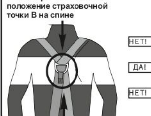
Рис. 6. Правильное положение страховочной точки В на спине
