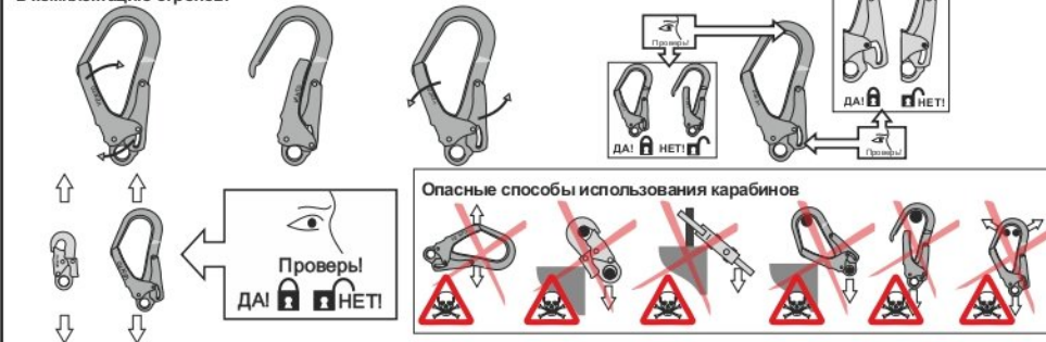
Рис. 6. Способы крепления стропов к анкерным устройствам
